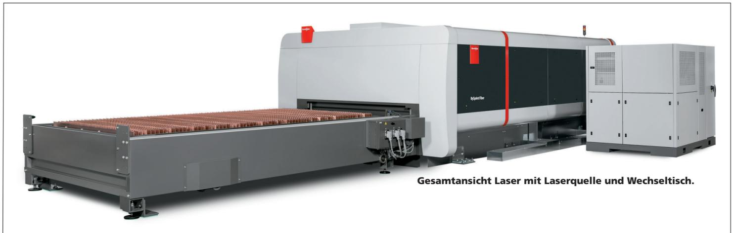
Gesamtansicht Laser mit Laserquelle und Wechseltisch.
