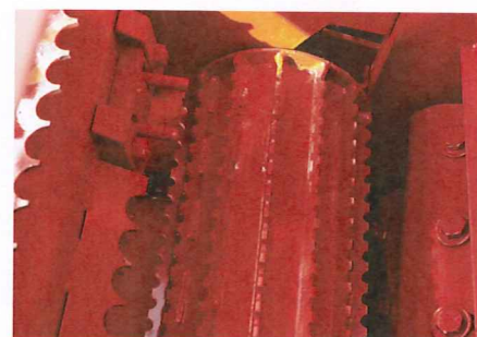
Das Futter wird von der Einzugs- in die Vorpresswalzen befördert.
