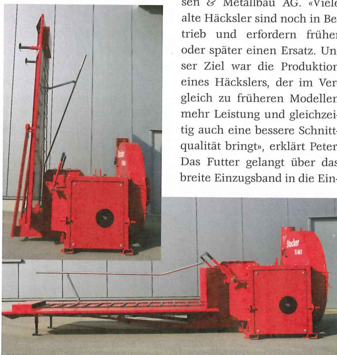
Der Trog des Standhäckslers lässt sich einfach hochklappen und mit dem 3-Punkte-Anbau problemlos transportieren.
